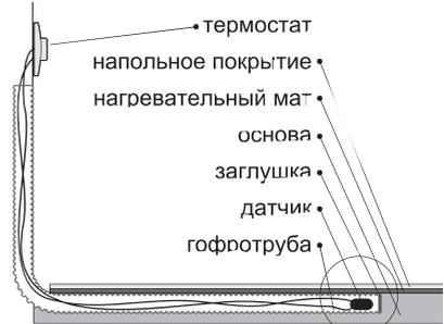
Прикрепите к поверхности пола стальную монтажную ленту, входящую в комплект набора. Равномерно уложите нагревательный кабель змейкой с расчетным шагом по поверхности, подлежащей обогреву, фиксируя кабель лепестками монтажной ленты.
