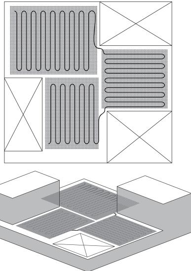
Ламинированное покрытие на основе МДФ укладывают на бетон без подложки. Не следует прокладывать между стяжкой и покрытием материалы, являющиеся теплоизоляторами. Клей для покрытия должен выдерживать нагрев.
