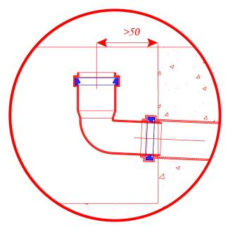
Установить в қанализационную трубу отвод 50х87.5. В зоне установки душевого трапа необходимо освободить зоны не менее 100х100мм. Убедиться, что расстояние от оси трубы отвода до стены превышает 50мм.
