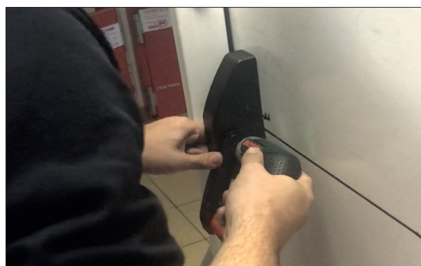
16. Установить балку с рычагами на механизмы. Зафиксировать рычаги. Винт №1 (2 шт.).
