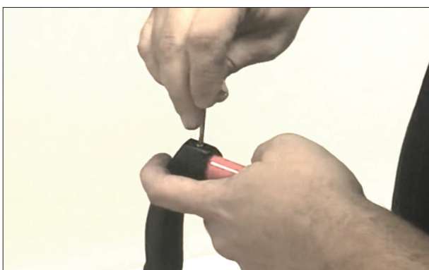
15. Зафиксировать нажимную балку в рычагах, используя ключ Аллена.
