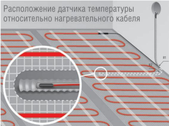
7. Уложите нагревательный мат по форме обогреваемого участка. Сетку необходимо резать на фрагменты, не затрагивая нагревательный кабель. В случае, если здание имеет термокомплексационные швы, термоматы должны быть расположены так, чтобы исключалась всякая возможность прохождения кабеля нагревательного мата через шов. Расстояние между полосами нагревательного мата и отступ от стен должны быть не менее 5 см.
