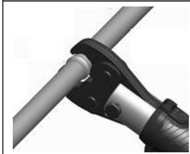
6.7. Для выполнения пресс-соединения установите пресс-насадку на фитинг так, чтобы монтажный буртик фитинга совпал с соответствующей канавкой пресс-насадки. Обратите внимание, чтобы не было перекоса между осью инструмента и осью пресс-насадки—это может привести к опасным повреждениям
