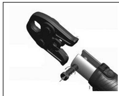
6.4. Нажмите и поверните стопорный палец 2, при этом за счет пружины он выдвинется. Вставьте пресс-насадку, нажмите и поверните стопорный палец.
