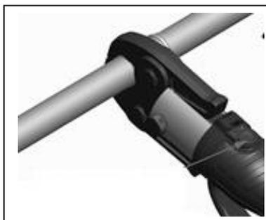
6.8. Нажмите кнопку пуска и выполните соединения. В случае ошибки, нажмите кнопку ручного возврата и вручную верните поршень в исходное положение
