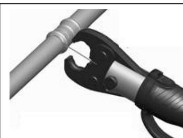
6.9. По окончании цикла опрессовки, поршень автоматически вернется в исходное положение. Снимите пресс-насадку с фитинга
