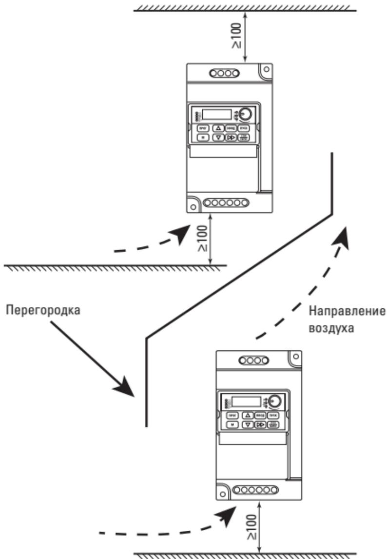
Рис.3 Монтаж при вертикальной установке нескольких преобразователей
