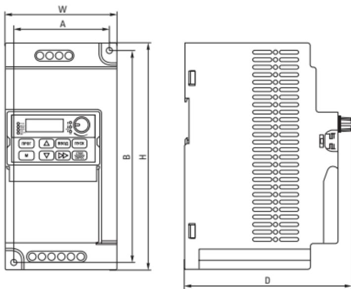
Рис. 1 Габаритные размеры преобразователей частоты VECTOR-80 EKF Basic
