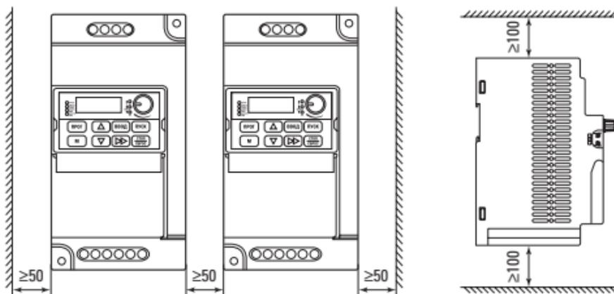
Рис.2 Монтаж при параллельной установке нескольких преобразователей
