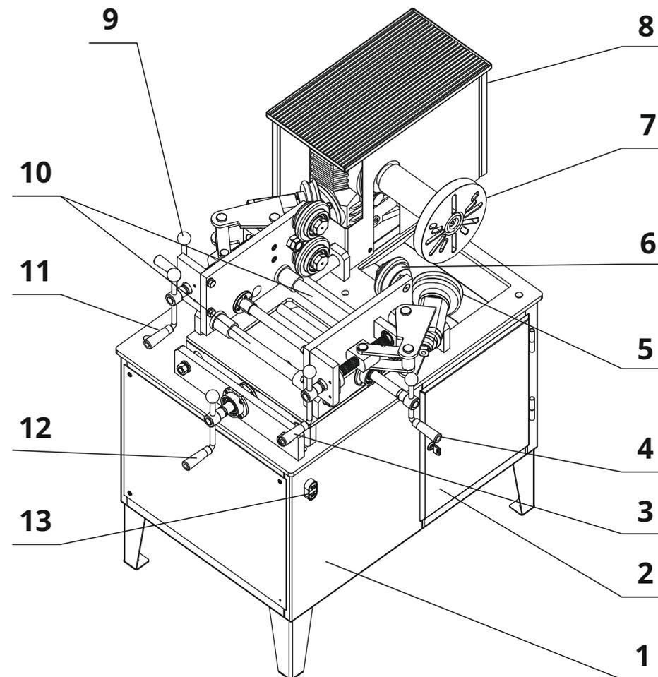
1- корпус (основание); 2 - дверь инструментального шкафа; 3, 11 - штурвал подвода прижимного ролика; 4 - штурвал перемещения правой каретки; 5 - прижимной ролик; 6 - опорный ролик; 7 - планшайба; 8 - кожух редуктора; 9 - штурвал перемещения левой каретки; 10 - направляющие; 12 - штурвал перемещения стола; 13 - станция пусковая.
