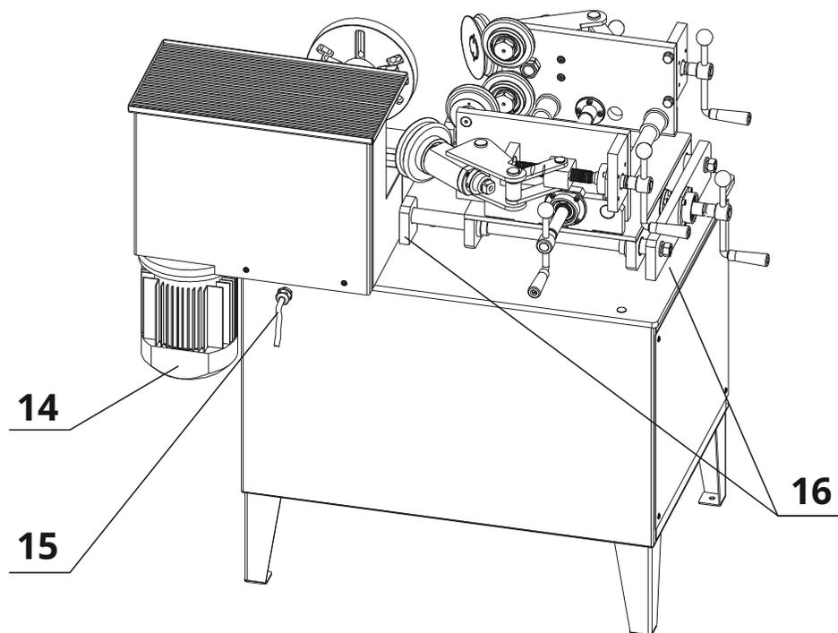
14 – мотор-редуктор; 15 – сетевой кабель; 16 – стойки направляющих.
