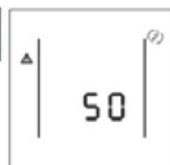
Горит красный светодиод ошибки, на LCD дисплее в области цифровой информации высвечивается код ошибки, а в области символов соответствующий значок ошибки , звучит непрерывный звуковой сигнал.
