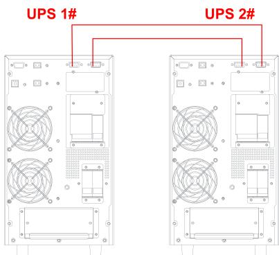
Аналогичным образом подключаются сигнальные кабели параллельной работы для трех или более ИБП. При подключении действуют следующие общие правила.
