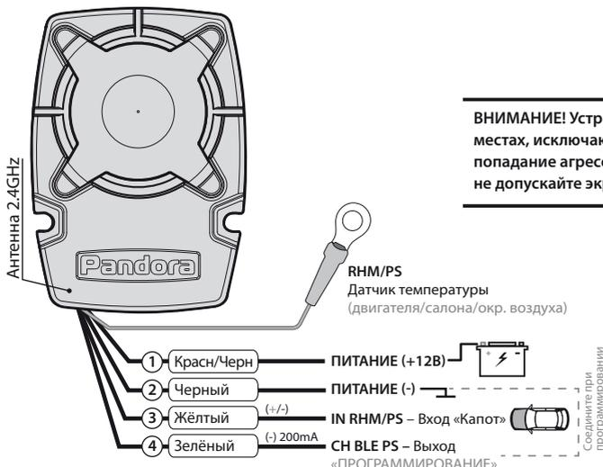
**ВНИМАНИЕ!** Устройство должно быть установлено в местах, исключающих механическое повреждение и попадание агрессивных жидкостей и влаги. При монтаже не допускайте экранирования встроенной антенны.
