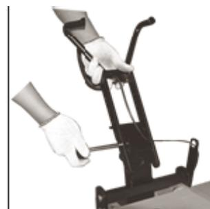
4. Потяните джойстик клапана управления расширением шины в сторону растяжения и растяните шину на необходимую ширину. Шина, вероятно, будет отходить от корпуса борторасширителя, если захват установлен слишком высоко. Продолжайте работу после переустановки захвата в более низкое положение.
