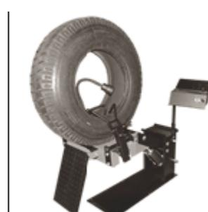
6. При необходимости установки шины в другое положение, пожалуйста, потяните вниз джойстик клапана управления высотой платформы, установите шину в правильное положение на устройстве, предварительно ослабив захват. После этого выполните необходимые работы.
