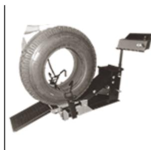
3. В соответствии с размером шины, ремонт которой необходимо произвести, установите механизм фиксации на необходимую высоту. Установите длинный захват так, чтобы он был соединен с рычагом подъемного устройства. Отрегулируйте положение захвата, передвигая рычаг с захватом вверх и вниз для того, чтобы совместить его с одним из семи (7) регулировочных отверстий. Поверните короткий захват внутрь шины и постарайтесь поместить шину посередине между прижимными рычагами.
