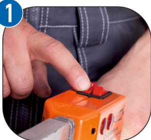
1 Установить сварочный аппарат на струбцину и закрепить насадки. Установить температуру 260°С на терморегуляторе сварочного аппарата
