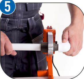
5 Одновременно начать движение трубы и фитинга на насадки сварочного аппарата. Выдержать время нагрева трубы и фитинга на насадках (от 5 до 10 секунд)
