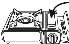
4. Зажгите огонь ,поворачивая регулятор против часовой стрелки до щелчка.
