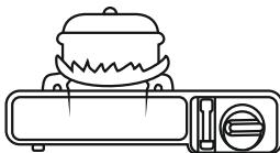
7. Поверните рычаг вверх в положение «Закрыто». Рычаг должен находиться в свободном (верхнем) положении, когда плита не используется .
