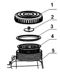
Рис. 2 Конструкция заливной горловины бака
