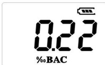
В случае если содержание паров алкоголя в выдыхаемом воздухе превышает допустимые пределы, экран загорится красным цветом, в случае незначительного содержания алкоголя экран загорится зеленым цветом. Для более точных результатов, сделайте несколько замеров, кратковременно нажав на кнопку «СТАРТ» для перехода в режим измерения.
