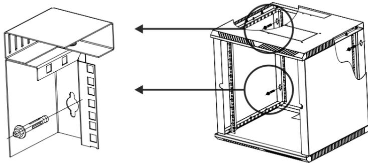
Установка задней стенки шкафа. Установите заднюю стенку и зафиксируйте при помощи четырех гаек (опция).
