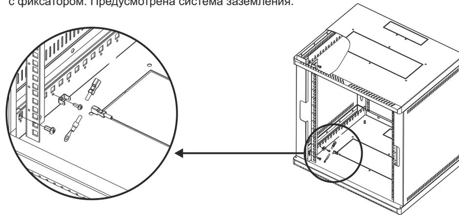
**2** Предусмотрена возможность установки двери с правой или левой стороны. Отведите вниз шпингалет и снимите дверь. Установите дверь. Переустановите замок. Подсоедините провод заземления.
