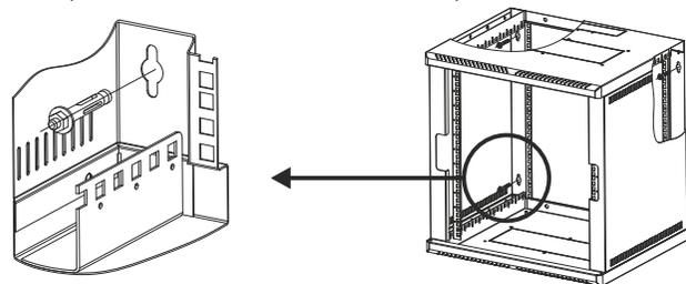
**Установка задней стенки шкафа.** Установите заднюю стенку и зафиксируйте при помощи четырех гаек (опция).
