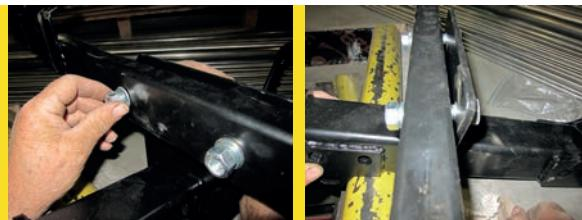
**При установке фаркопа совместно с защитой заднего бампера сначала устанавливается защита, затем фаркоп!**
