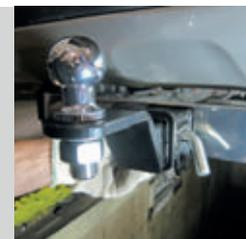
Тип шара «Е»; Тип соединения: шаровый; Диаметр сцепного шара: 50 мм.; Масса комплекта ТСУ 06051501: 25 кг.
