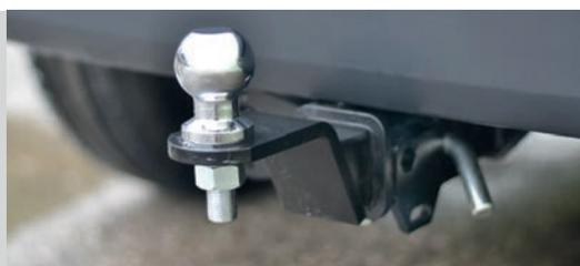
Тип шара «Е»; Тип соединения: шаровый; Диаметр сцепного шара: 50 мм.; Масса комплекта ТСУ 01301501: 20 кг.
