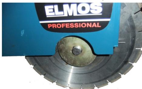
4) Установите и прочно затяните гайку крепежа диска с помощью специального ключа.
