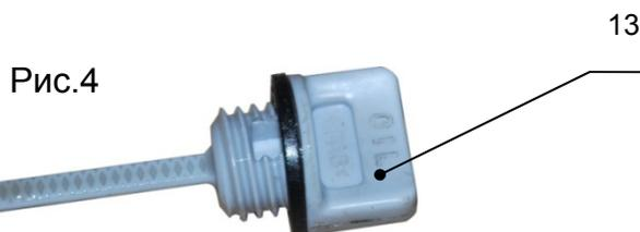
Если уровень масла низкий, заполните картер двигателя маслом до верхнего края маслосливной горловины. Поскольку емкость масляного картера маленькая, во избежание перелива добавляйте масло медленно. Проверяйте уровень масла перед каждым использованием и каждые 10 часов непрерывной эксплуатации. Используйте только высококачественное моторное масло. Меняйте масло после первых 10 часов эксплуатации или каждые 50 часов для увеличения ресурса двигателя.
