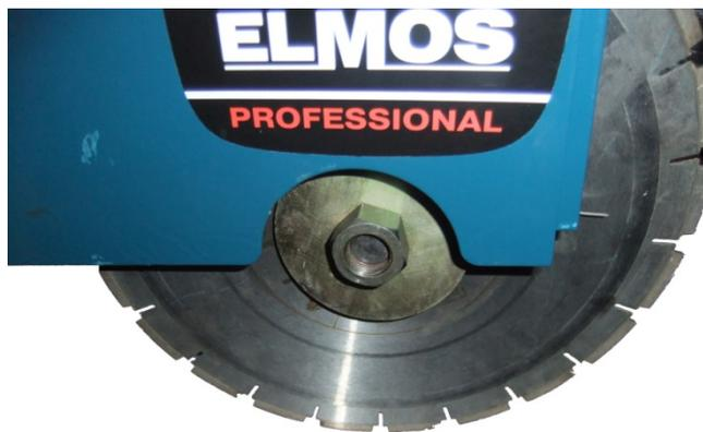
5) Опустите вниз крышку диска. Демонтаж производится в обратной последовательности.
