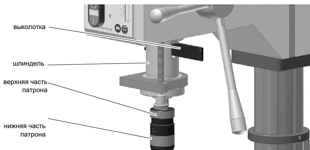
Рис. 4-8: Снятие патрона с помощью выколотки
