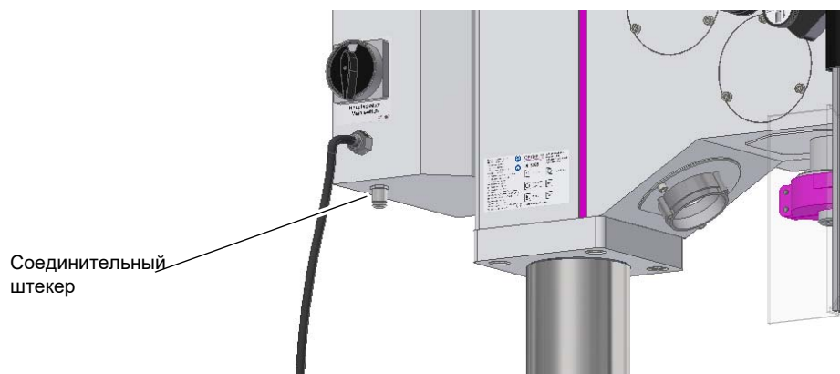
Рис. 3-6: Штекерный разъем ножного переключателя
