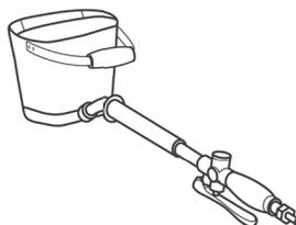
3. Установить спусковую рукоятку и соединитель воздухозаборника для завершения установки.
