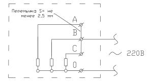
Примечание: При подключении на 3 фазы использовать кабель минимального сечения 3x1,5+1x1,5 мм. Для подключения на одну фазу использовать кабель минимального сечения 2x4мм.
