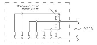
Примечание: При подключении на 3 фазы использовать кабель минимального сечения 3x1,5+1x1,5 мм<sup>2</sup>. Для подключения на одну фазу использовать кабель минимального сечения 2x4мм.<sup>2</sup>
