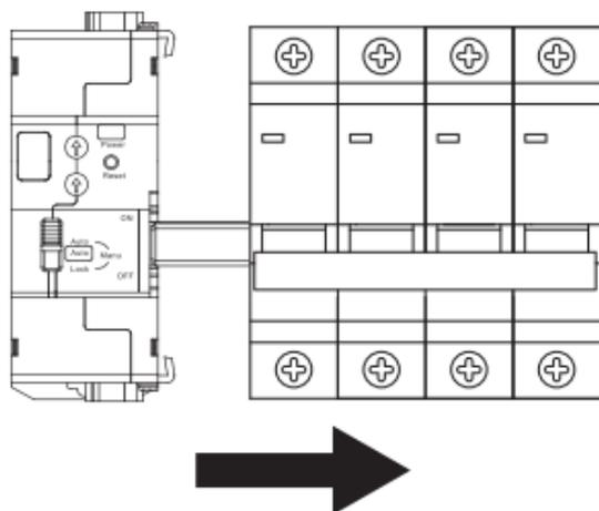
Рис. 4 Присоединение моторного привода
