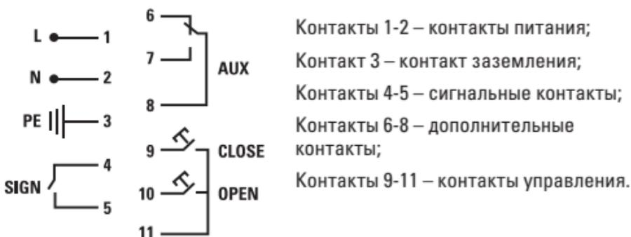
Рис. 5 Подключение привода
