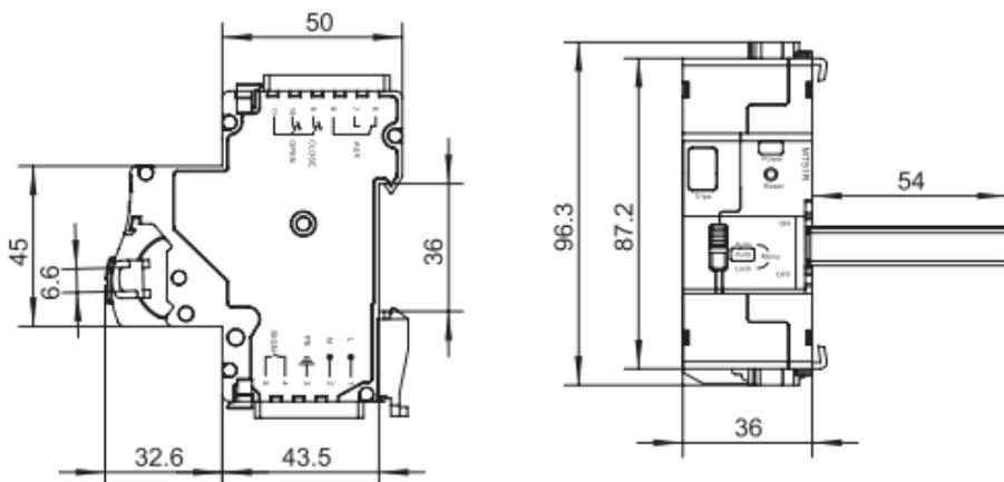
Рис.3 Габаритные и установочные размеры привода AV-M6
