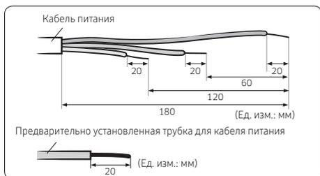
3 Вставьте оба конца сердечника силового кабеля в соединительную муфту.
