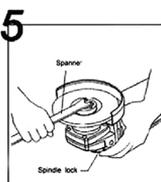
1. Нажмите кнопку стопора вала, слегка проверните шпиндель до фиксации. Затяните наружный фланец при помощи ключа для наружного фланца (Рис.5).
