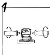
ее справа или слева от редукторной головки в зависимости от способа работы (Рис.1).
