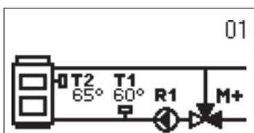
В меню выбора гидравлической схемы для работы регулятора, перемещение по схемам производится с помощью клавиш (+) и (-). Выбранная схема подтверждается нажатием клавиши (✓).
