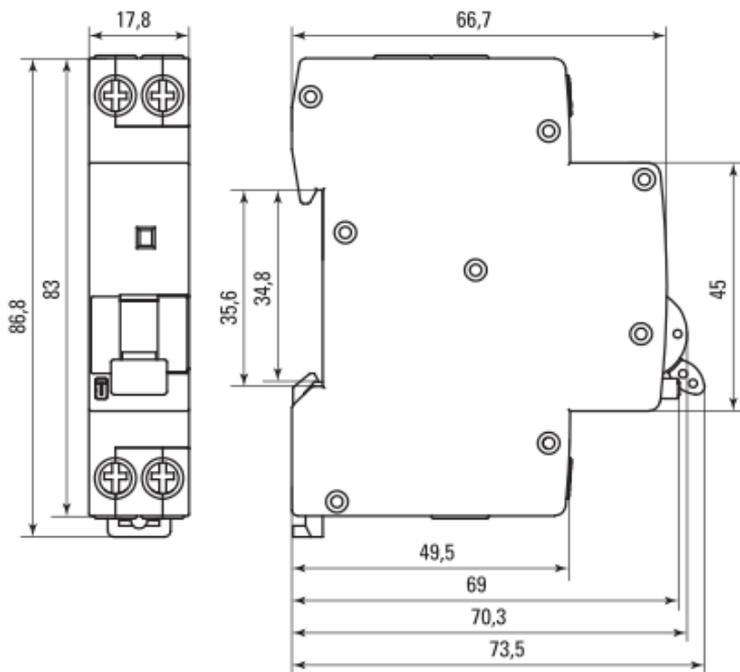
Рис. 2 Габаритные размеры АВДТ-63М
