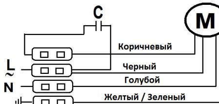
**МОНОФАЗНОЕ ПОДКЛЮЧЕНИЕ МОДЕЛЕЙ С BSM 550 ПО BSM 600**
