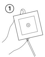
Снять внутреннюю часть лицевой части розетки, путем легкого отжатия наконечником плоской отвертки металлической части и декоративной рамки.
