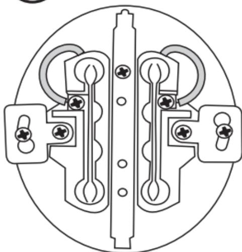
Установить механизм изделия в углубление стены, зафиксировать стопорные и крепежные винты на корпусе изделия, затянув их до упора.
