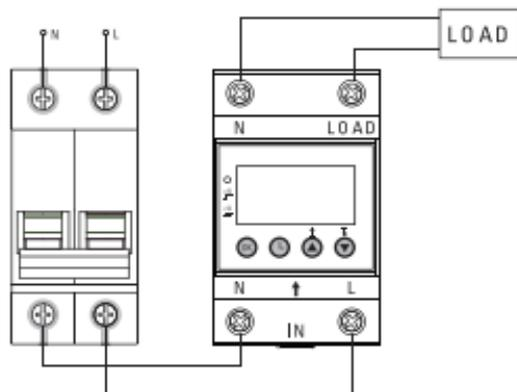
Рис. 9 Схема подключения
