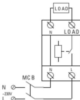
Рис. 8 Условная схема подключения
