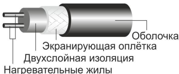
Рисунок 3 – Устройство нагревательного провода.
