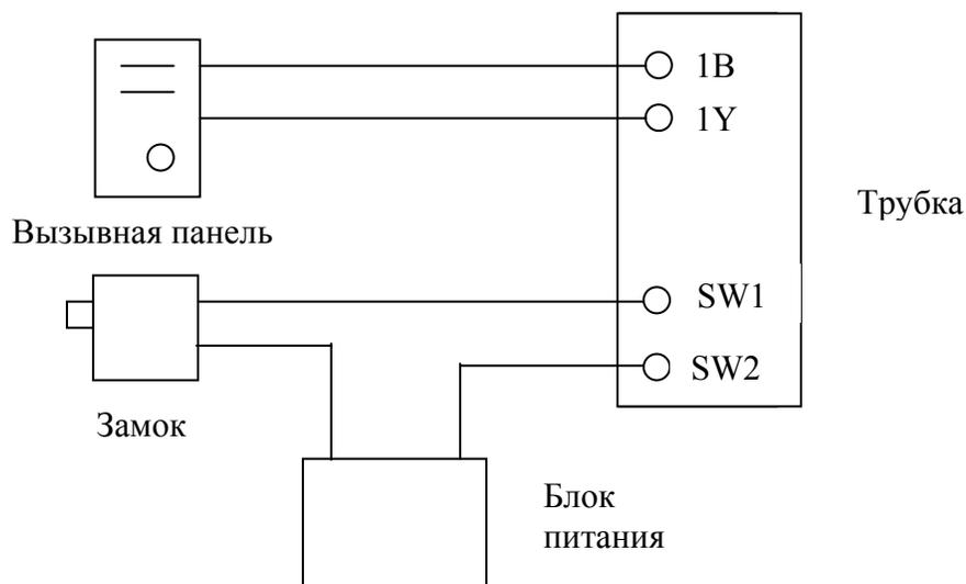
**Примечание: Вызывная панель подключается без соблюдения полярности. Кнопка открывания замка: нормально разомкнутая. Параметры блока питания выбираются по параметрам замка.**
