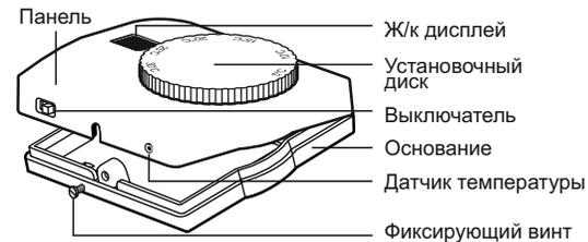
Монтаж ТЕРМОСТАТА производится следующим образом:
