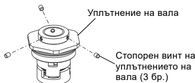
Фиг. 8 Уплътнение на вала и стопорни винтове на уплътнението на вала за CR, CRI, CRN 1s, 1, 3, 5, 95, 125, 155, 185, 215, 255
