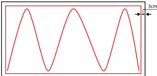
Подождите от 2 до 8 минут (20°C; 65% RH – время можно уменьшить при более высокой температуре / влажности и увеличить при более низкой температуре / влажности), а затем прижмите изоляционную панель к стене. Работайте в направлении снизу вверх без пропусков. В углах
