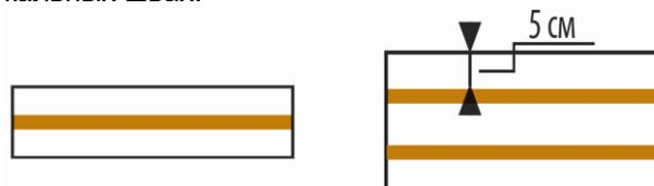
Присоедините и выровняйте блоки в течение от 2 до 8 мин. (20°C; 65% RH – время можно уменьшить при более высокой температуре / влажности и увеличить при более низкой температуре / влажности). Если кирпич был отсоединён, для повторного приклеивания нужно снова нанести клей точками. Излишки клея удалите шпателем. В зависимости от температуры окружающей среды, работа может быть продолжена после мин. 1 часа. Полная прочность клея достигается через мин. 12 ч.
