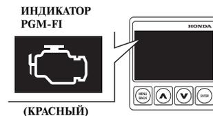
При неисправности системы управления двигателем PGM-FI включается индикатор PGM-FI и подается звуковой сигнал зуммера.
