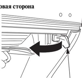
ЗАМОК КОЖУХА ДВИГАТЕЛЯ
