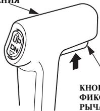
КНОПКА ФИКСАТОРА РЫЧАГА В НЕЙТРАЛЬНОМ ПОЛОЖЕНИИ
