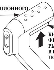
КНОПКА ФИКСАТОРА РЫЧАГА В НЕЙТРАЛЬНОМ ПОЛОЖЕНИИ
