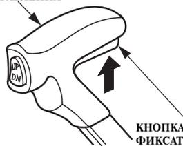
КНОПКА ФИКСАТОРА РЫЧАГА В НЕЙТРАЛЬНОМ ПОЛОЖЕНИИ
