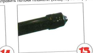
По окончанию усадки до полного остыивания оконцеватель не должен подвергаться механическим воздействиям.
