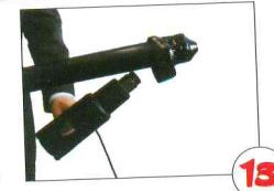
Продолжить прогрев оконцевателя равномерно со всех сторон до его полной усадки.
