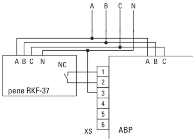
Рисунок 2. Схема подключения с применением реле контроля фаз
