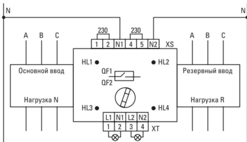
Рисунок 1. Схематичное изображение лицевой панели АВР МСВ
