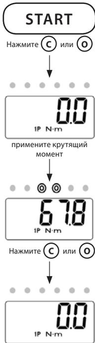
Примененный момент зафиксирован. При достижении момента прозвучит 3 звуковых сигнала. Светодиод загорается в соответствии с заданным допуском.
