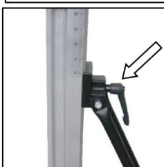
Откройте зажимной рычаг на опоре. Установите колонну стойки под необходимым углом, снова плотно затяните винты и закройте рычаг.
