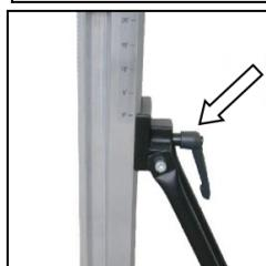
Afloje la palanca de sujeción del soporte.
