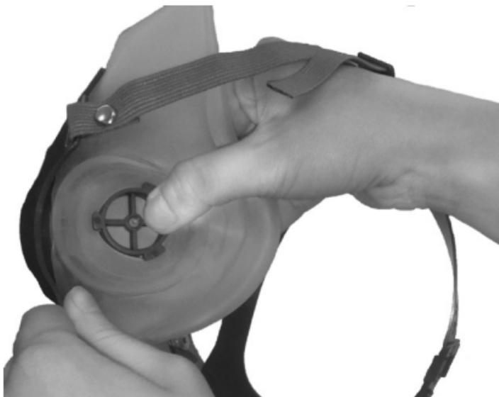
Рисунок 2 – Снятие защитного экрана
