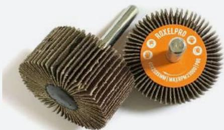
Разработаны с целью предоставить однородную конечную поверхность с равномерным шлифованием. Лепестковые круги обладают равномерным износом, благодаря которому появляются новые абразивные зерна. Их конструкция делает их идеальными для шлифования контуров и неровных кромок.
