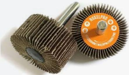
Разработаны с целью предоставить однородную конечную поверхность с равномерным шлифованием. Лепестковые щетки обладают равномерным износом, благодаря которому появляются новые абразивные зерна. Их конструкция делает их идеальными для шлифования контуров и неровных кромок.
