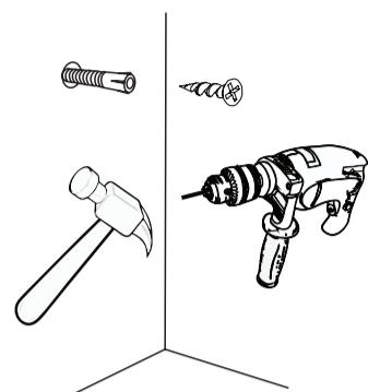
**ВНИМАНИЕ!** В комплектацию входит дюбель, предназначенный только для бетонных и кирпичных стен. Для гипсокартонной стены дюбеля подобрать самостоятельно, а так же изготовить усиленный каркас для правильного распределения нагрузки тумбы.
