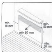
Рекомендуемая схема установки конвектора на стене.
