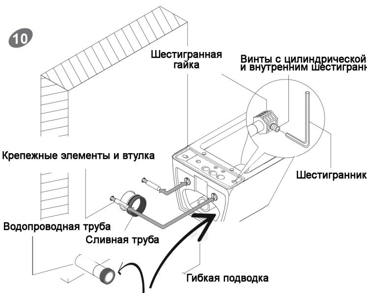
При установке необходимо использовать гибкую подводку (входит в комплект) для подсоединения унитаза к водопроводной системе с помощью переходника с 3/4 на 1/2 (входит в комплект).
