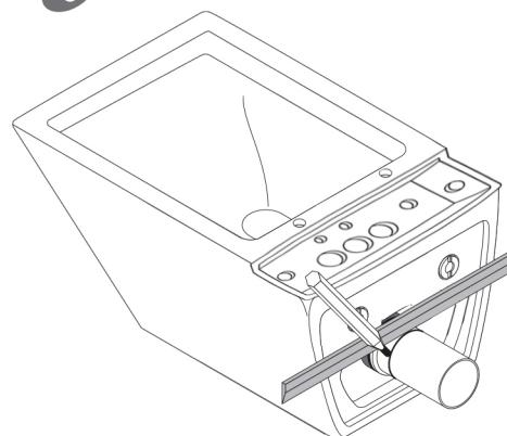
Вставьте фановую трубу от инсталляции в сливную и подсоедините ее в задний отвод подвесного унитаза.
