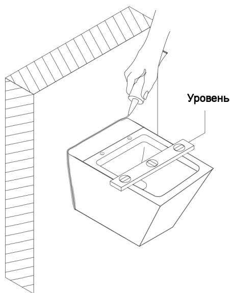
Удостоверьтесь, что унитаз плотно закреплен и не шатается. После выравнивания нанесите силиконовый герметик на место стыка по всей длине.
