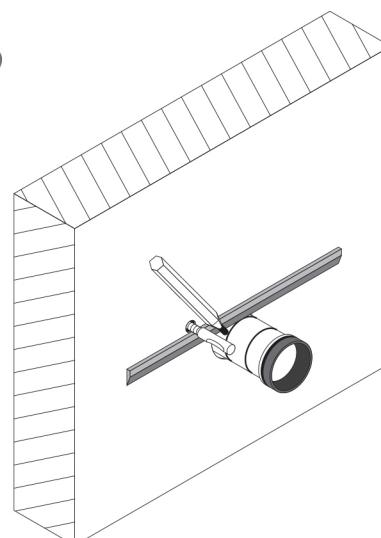
Вставьте сливную трубу во внутреннее отверстие с отводом в стене и начертите разметку карандашом как показано на рисунке
