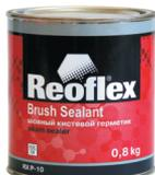
Шовный кистевой герметик предназначен для герметизации металлических стыков и сварных швов при кузовном ремонте. Обладает отличными антикоррозионными и звукоизолирующими свойствами. Легко наносится, образует эластичное покрытие. Стоек к воздействию внешней среды.
