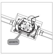
Установите монтажную коробку на место установки смесителя и отрегулируйте положение коробки с помощью датчика уровня.
