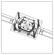
Закрепите монтажную коробку при помощи винтов к полу.
