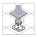
Аккуратно установите трубу с фиксатором в водопроводные отверстия в монтажной коробке. Затяните фиксатор винтами к монтажной коробке
